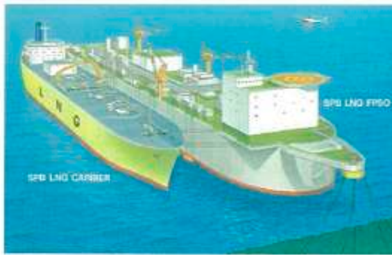
Fig. 4 Schematic illustration of LNG FPSO
