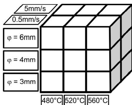
**Fig. 2** Experimental plan.
